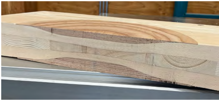
Örtliche Holzverdichtung, Pressen und Verkleben von gebogenen Hartholzdübeln in den CLT-Querschnitt
